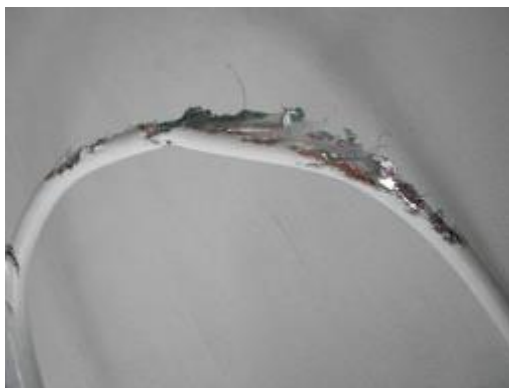
Figure 19 : RJ45 dévoré par les rongeurs
