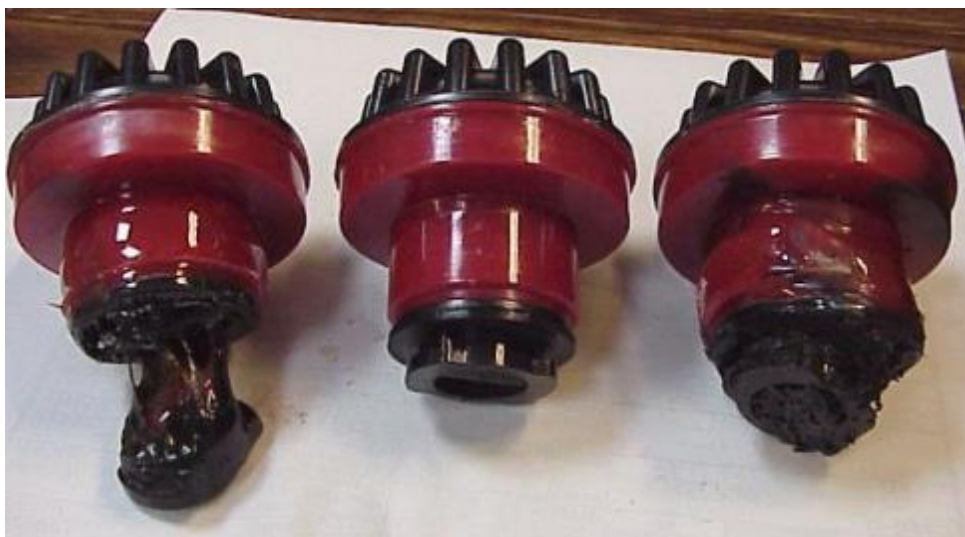
Figure 18 : Recombineurs Hydrocaps® fondu lors d'une charge d'égalisation poussée
