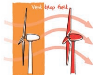
ROTOR "À PAS VARIABLE" : LA MACHINE ROUGE EST MISE EN DRAPEAU : SES PALES ONT PIVOTÉ POUR PRÉSENTER MOINS DE PRISE AU VENT.
